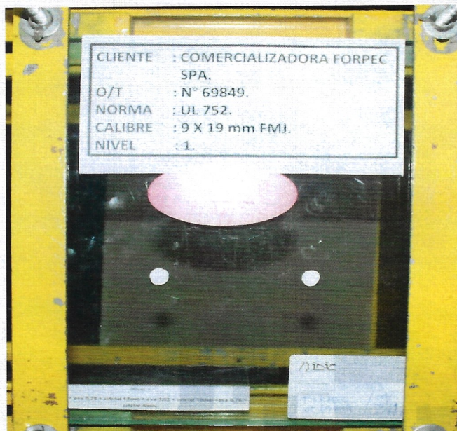
Vista Frontal Antes del ensayo con cal. 9 x 19 mm FMJ
