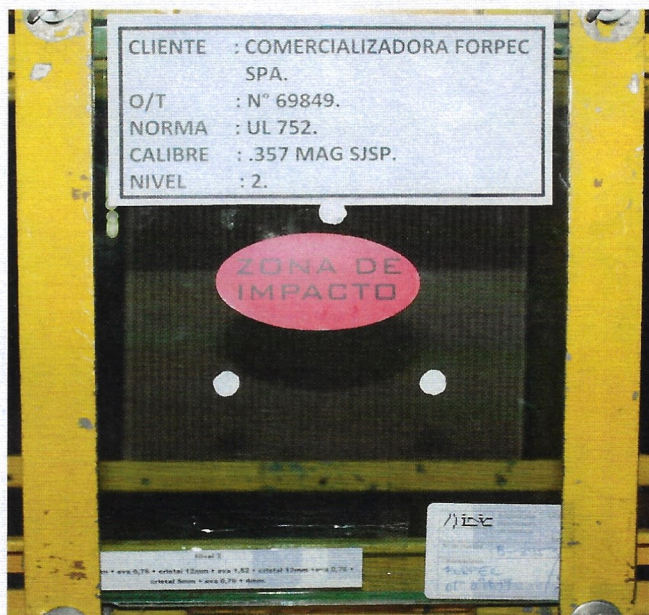
Vista Frontal Antes del ensayo con cal. .357 MAG. SJSP
