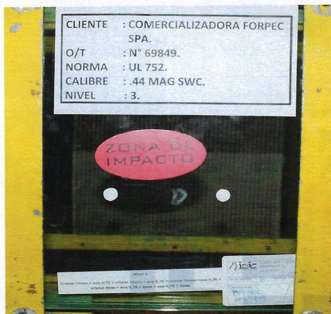
Vista Frontal Antes del ensayo con cal. .44 MAG. SWC.
